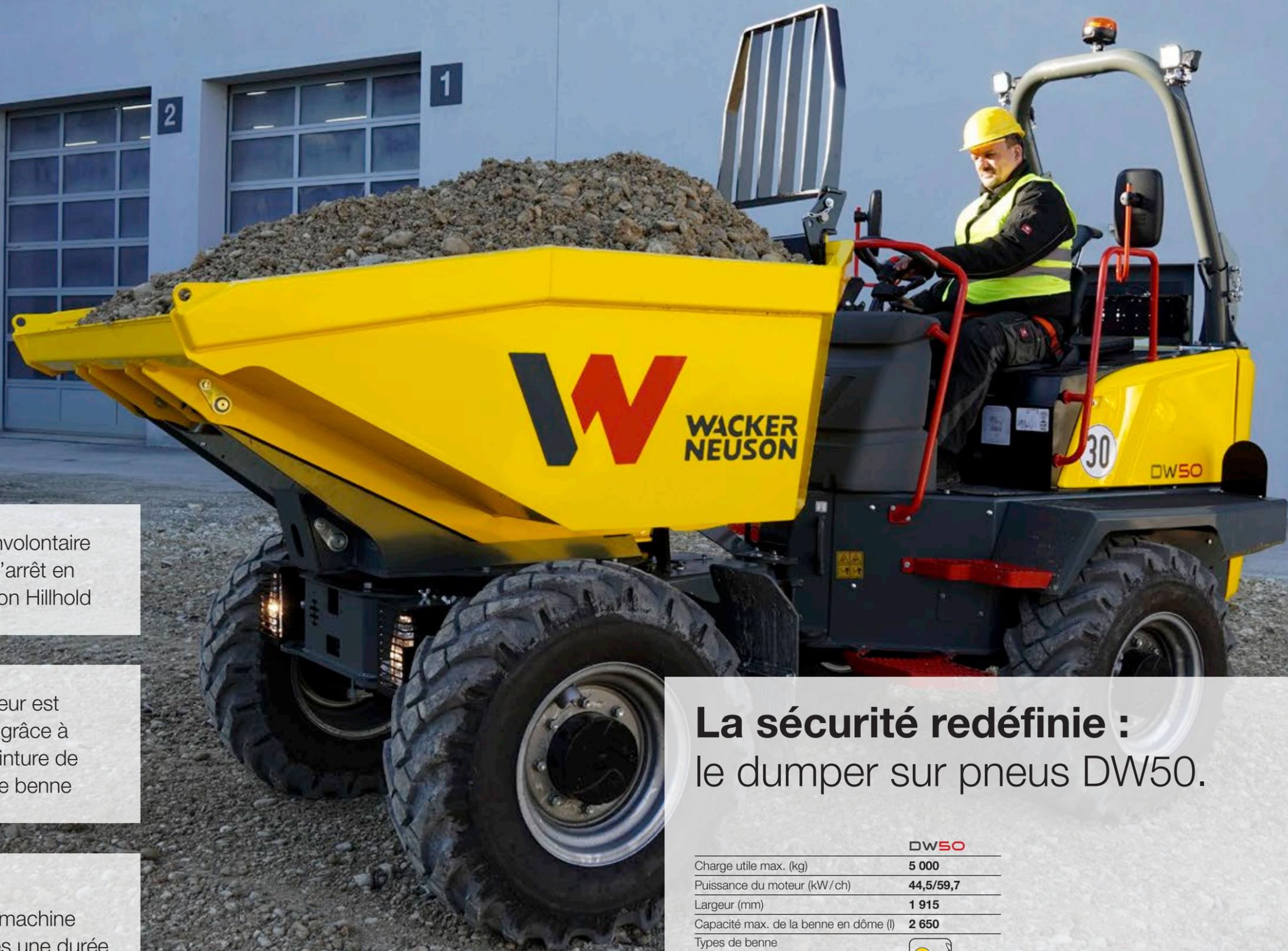
Pas de déplacement involontaire de la machine lors de l'arrêt en pente grâce à la fonction Hillhold
