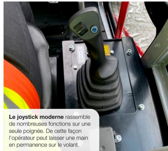
**Le joystick moderne** rassemble de nombreuses fonctions sur une seule poignée. De cette façon l'opérateur peut laisser une main en permanence sur le volant.
