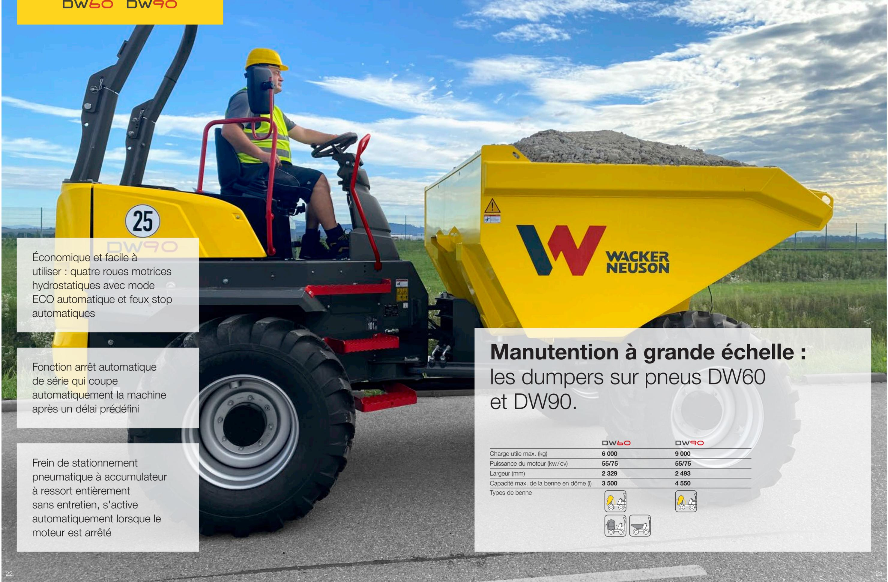
Économique et facile à utiliser : quatre roues motrices hydrostatiques avec mode ECO automatique et feux stop automatiques
