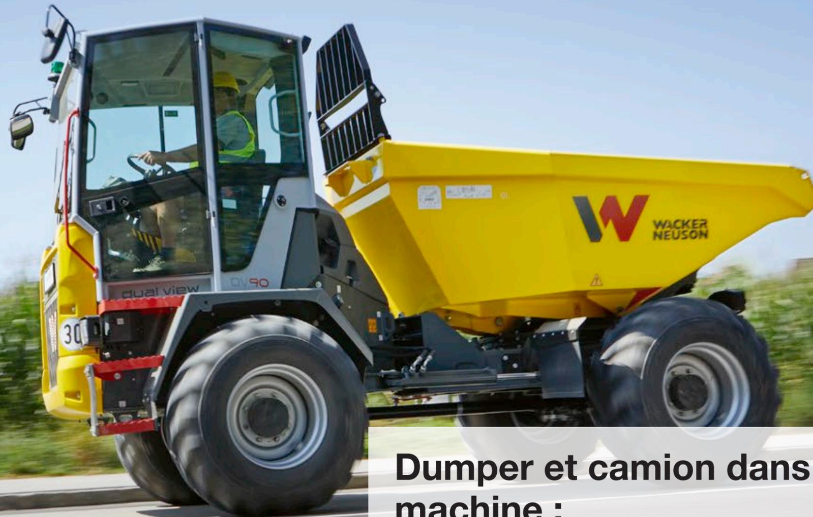
Concept innovant Dual View : le siège conducteur pivote à 180 degrés pour assurer une visibilité optimale lors du chargement et de la conduite
